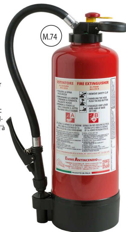
Extincteur pressurisé au moment de l'utilisation avec cartouche de CO2 de 55 gr
